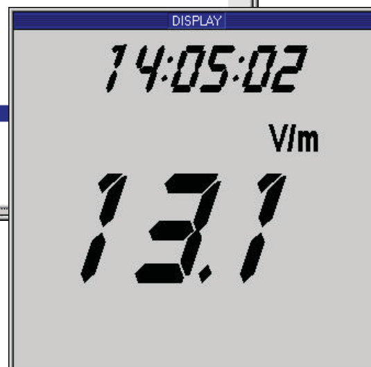
Ejemplo de visualización del display del CA 43 en funcionamiento "on-line"
