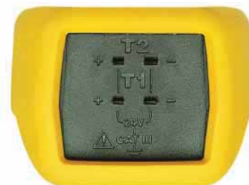
Modelo CA863 Termómetro 2 entradas termopar tipo K para medidas de diferencia de temperaturas
