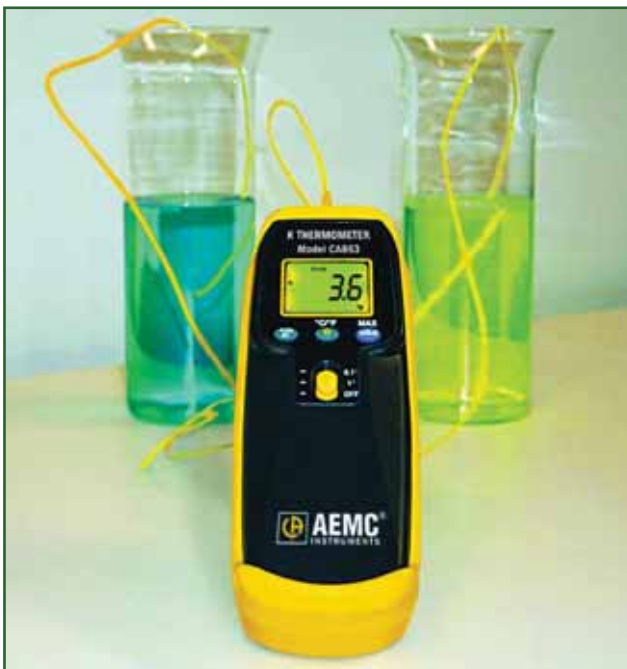
Toma simultánea de dos temperaturas con lecturas de las medidas individuales y/o la diferencial simplemente pulsando un botón.
